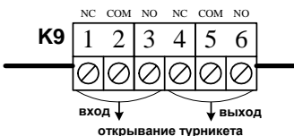
Пример 5. Подключение турникета (турникетный режим)
