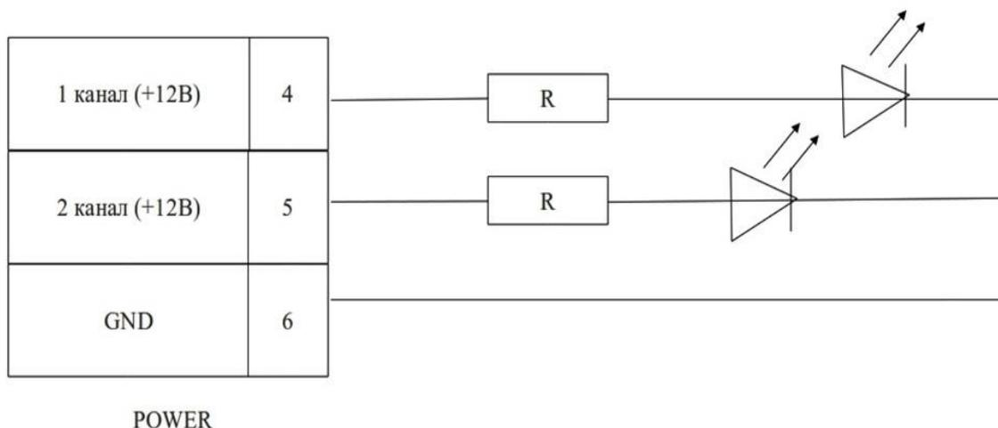
При этом важно понимать, что эти контакты не являются сухими контактами реле. В случае считывания валидной карты по данному каналу считыватель выдает на данные контакты напряжение + 12В, транслируя его со своего источника питания. Поэтому использование в качестве индикации ламп накаливания с большим током потребления (более 100mA) допустимо только через промежуточное реле.
