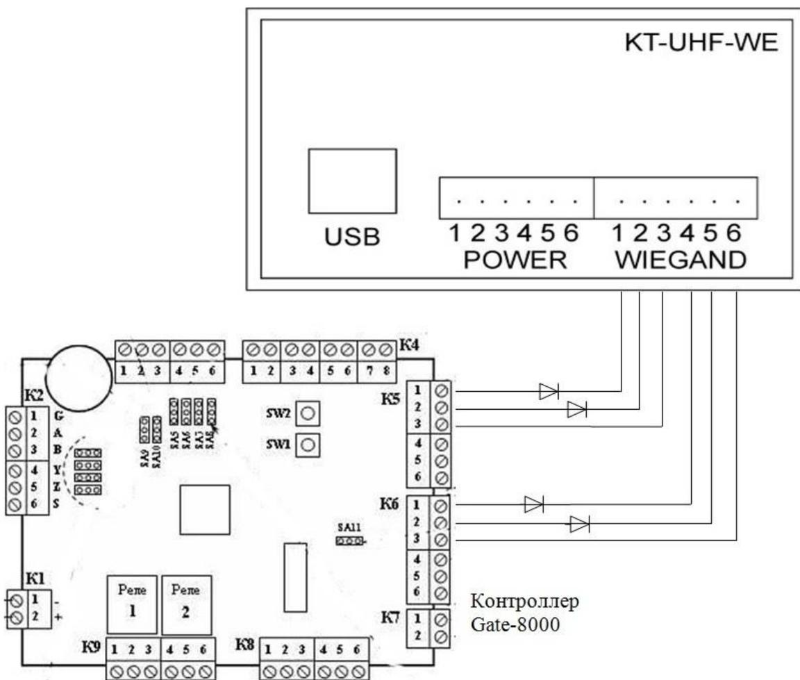
4. При реализации проектов с использованием считывателей KeyTex-Gate настоятельно рекомендуется использовать сигнализацию самого считывателя о факте обнаружения валидной метки в зоне считывания. Это существенно облегчает не только настройку системы, но и ее эксплуатацию. Индикация, подключенная к данным сигнальным выходам, позволяет пользователям убедиться в благополучном считывании системой их метки при въезде в зону.
