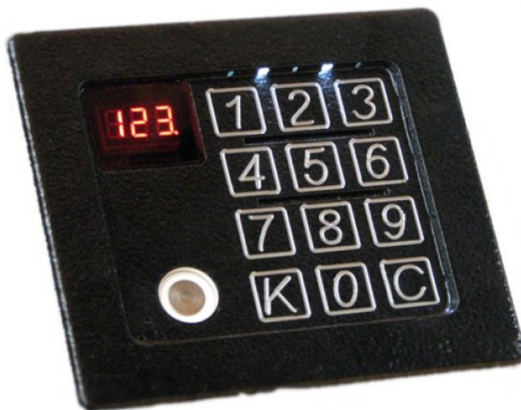
Рисунок 2.1 – Конструкция кодонаборного поля на оптопарах
