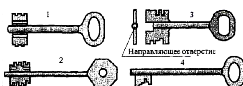
Рисунок 10 - Примеры ключей для сувальдных МС: 1-3 - двухсторонние; 4 - односторонний
